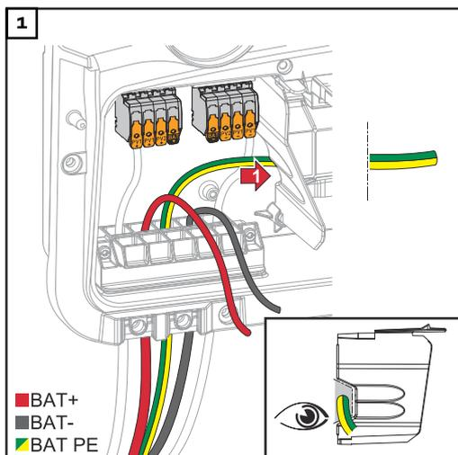
Posare il conduttore di terra della batteria nella canalina portacavi integrata del separatore della scatola dei collegamenti CA.
