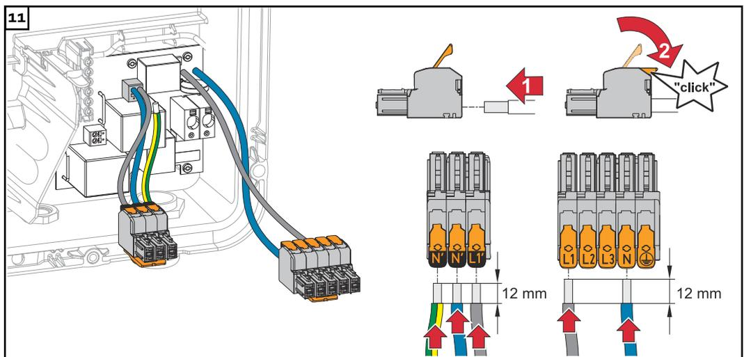
Spelare 12 mm di isolamento dai singoli conduttori. Aprire la leva di azionamento del morsetto CA sollevandola e inserire il singolo conduttore spelato nello slot del morsetto CA fino all'arresto. Chiudere quindi la leva di azionamento fino all'innesto.
