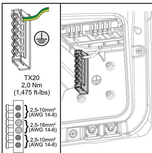
Il morsetto dell'elettrodo di terra ⊕ offre la possibilità di mettere a terra altri componenti, come ad esempio:
