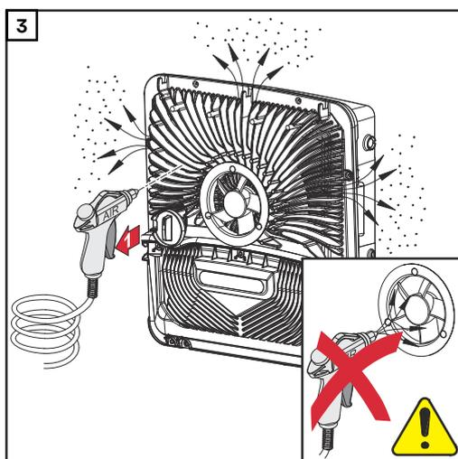
Rimuovere i depositi di sporco sul dissipatore di calore e sulla ventola con aria compressa, un panno o un pennello.
