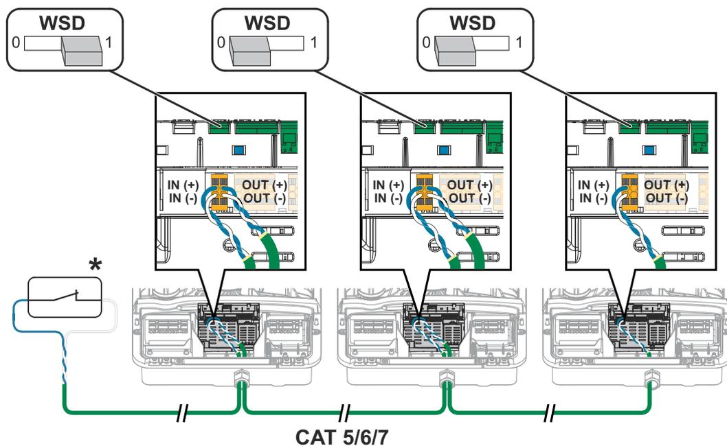
\* Contatto a potenziale zero del dispositivo di attivazione (ad es. protezione centrale NA). Se in una catena WSD vengono utilizzati più contatti a potenziale zero, occorre collegarli in serie.
