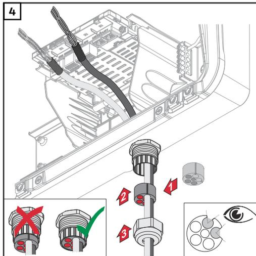
Inserire l'anello di tenuta tra il dado per raccordi e l'apertura del corpo. Premere i cavi dati nel passaggio dei cavi della tenuta. Quindi premere la tenuta fino al bordo inferiore del pressacavo.
