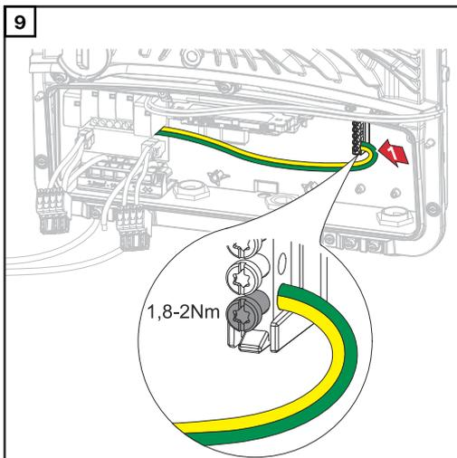
Fissare il conduttore di terra al primo ingresso dal basso sul morsetto dell'elettrodo di terra con un cacciavite (TX20) e una coppia di serraggio di 1,8-2 Nm.
