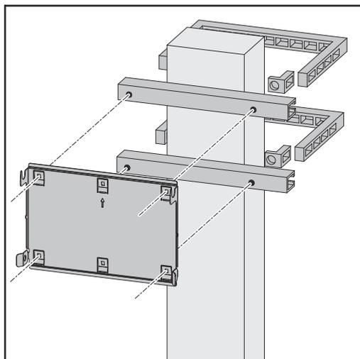
Per il montaggio dell'inverter su un palo o un supporto, Fronius consiglia il kit di fissaggio "Pole clamp" (N. ordine SZ 2584.000) della ditta Rittal GmbH.
