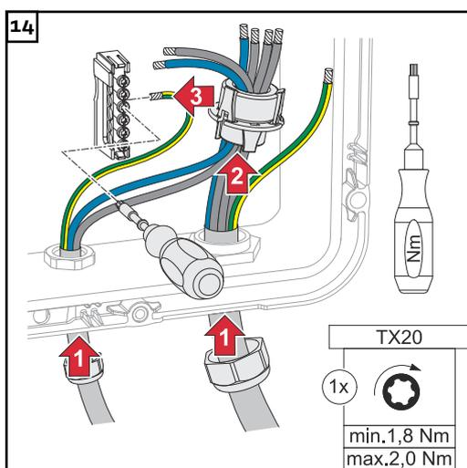
Far passare i conduttori di fase/neutri attraverso il nucleo di ferrite. Fissare il conduttore di terra al terzo ingresso partendo dall'alto sul morsetto dell'elettrodo di terra con un cacciavite (TX20) e una coppia di serraggio di 1,8-2 Nm.
