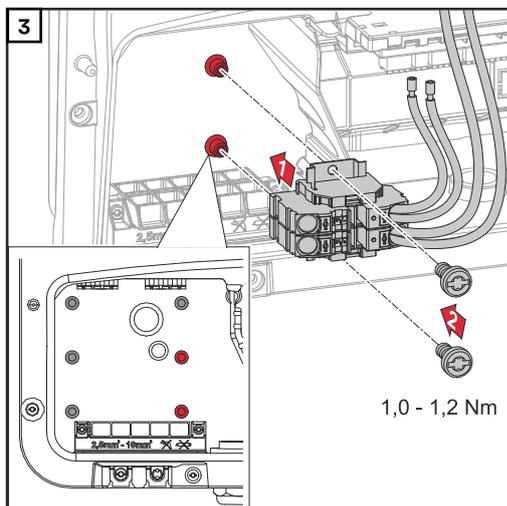
Inserire il DC Connector GEN24 nell'inverter e fissarla con le 2 viti (TX20) in dotazione e una coppia di serraggio di 1,0-1,2 Nm.
