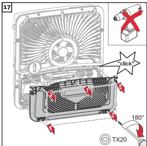
Posizionare il coperchio sulla scatola dei collegamenti. Fissare le 5 viti nell'ordine indicato con un cacciavite (TX20) e ruotandole di 180° verso destra.
