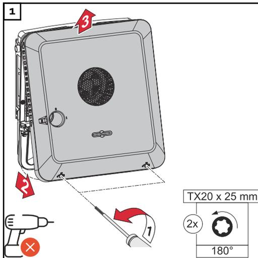
Allentare le 2 viti sul fondo del coperchio del corpo con un cacciavite (TX20) e un giro di 180° verso sinistra. Sollevare quindi il coperchio del corpo esterno sul lato inferiore dell'inverter e sganciarlo verso l'alto.
