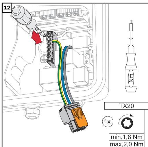
Fissare il collegamento PEN compreso nella fornitura sul secondo ingresso partendo dall'alto al morsetto dell'elettrodo di terra con un cacciavite (TX20) e una coppia di serraggio di 1,8-2 Nm.
