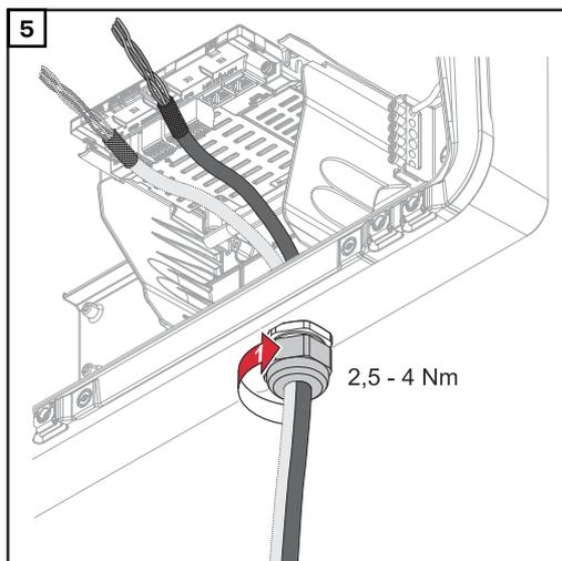
Fissare il dado per raccordi del pressacavo con una coppia di min. 2,5 - max. 4 Nm.
