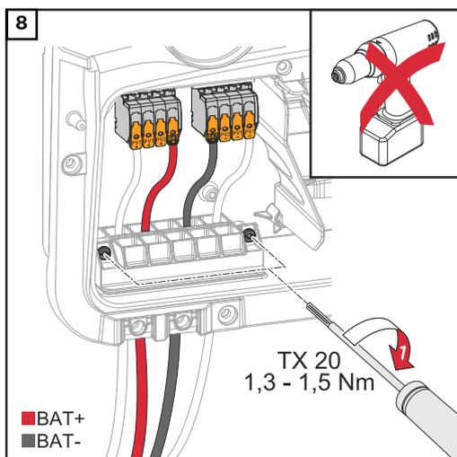
Fissare le viti del passaggio dei cavi al corpo esterno con un cacciavite (TX20) e una coppia di serraggio di 1,3-1,5 Nm.
