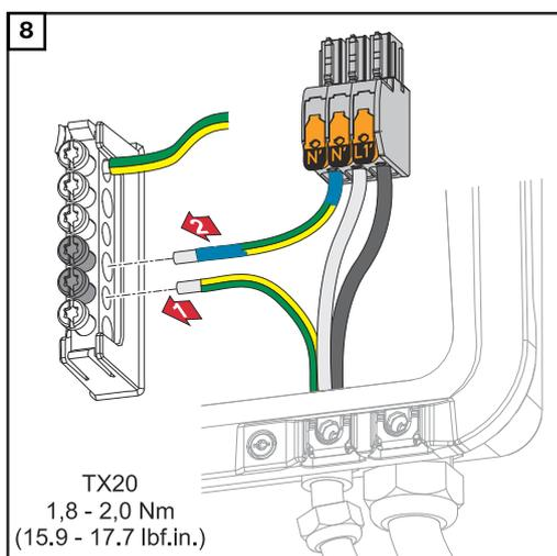
Fissare il conduttore di terra e il conduttore PEN al morsetto dell'elettrodo di terra con un cacciavite (TX20) e una coppia di serraggio di 1,8-2 Nm.
