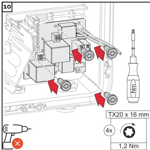
Fissare la scheda elettronica con le 4 viti (TX20) comprese nella fornitura e una coppia di serraggio di 1,2 Nm.
