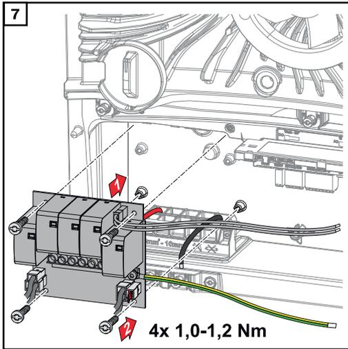
Inserire la scheda elettronica nell'inverter e fissarla con le 4 viti (TX20) in dotazione e una coppia di serraggio di 1,0 - 1,2 Nm.
