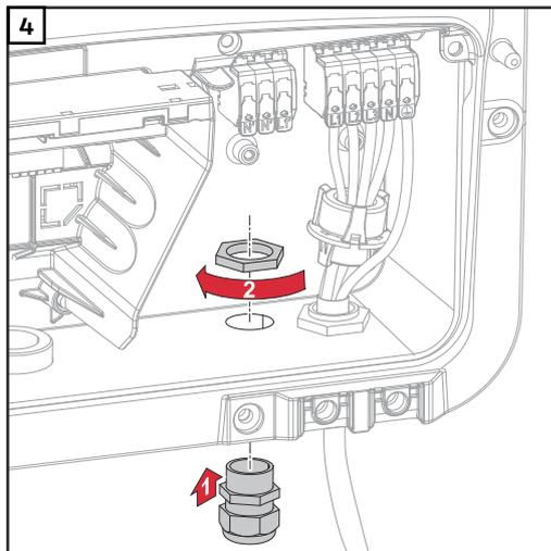
Inserire il pressacavo nel foro e fissare con la coppia specificata dal produttore.
