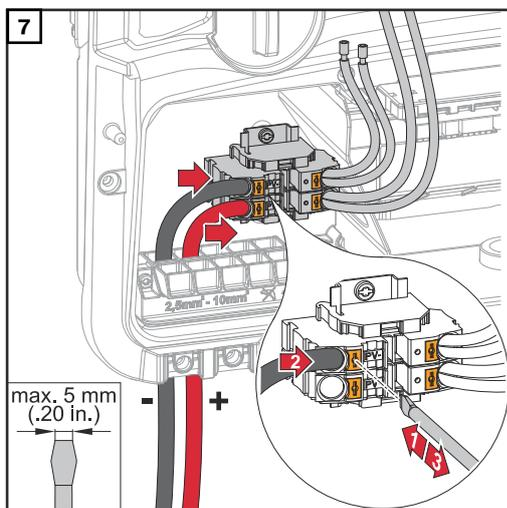
Premere il blocco del morsetto con un cacciavite a taglio. Inserire il singolo conduttore spellato nel rispettivo slot fino all'arresto nel morsetto. Dopo di che, rimuovere il cacciavite a taglio dal blocco.
