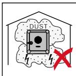
Fondamentalmente l'inverter è realizzato a tenuta di polvere (IP66). Tuttavia, nelle aree che presentano forti accumuli di polvere, le superfici di raffreddamento possono impolverarsi compromettendo così l'efficienza termica. In questo caso è necessaria una pulizia regolare, vedere capitolo [Utilizzo in ambienti in cui vi è una produzione massiccia di polveri](#) a pagina 183. È pertanto sconsigliato il montaggio in locali e ambienti caratterizzati da un massiccio sviluppo di polveri.
