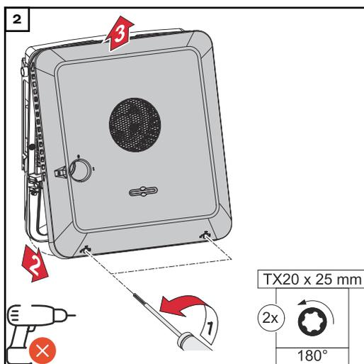
Allentare le viti sul fondo del coperchio del corpo con un cacciavite (TX20) e un giro di 180° verso sinistra. Sollevare quindi il coperchio del corpo esterno sul lato inferiore dell'inverter e sganciarlo verso l'alto.
