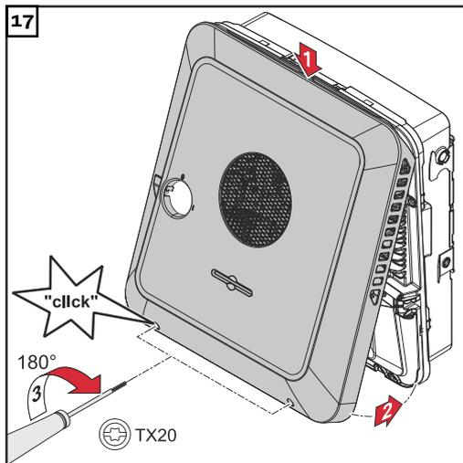
Agganciare il coperchio del corpo esterno all'inverter dall'alto. Premere la parte inferiore del coperchio del corpo e fissare le 2 viti con un cacciavite (TX20) e ruotandole di 180° verso destra.
