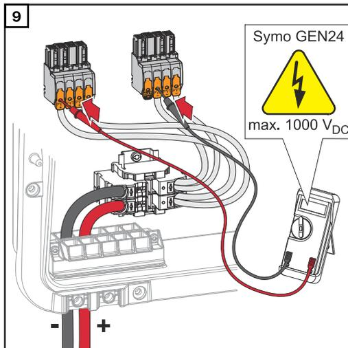
Controllare la tensione e la polarità del cablaggio CC con uno strumento di misura adeguato.
