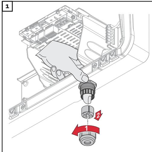
Allentare il dado per raccordi del pressacavo e premere l'anello di tenuta con le viti cieche dall'interno dell'apparecchio.
