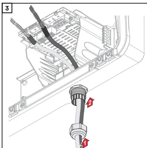
Far passare il cavo dati prima attraverso il dado per raccordi del pressacavo e quindi attraverso l'apertura del corpo.
