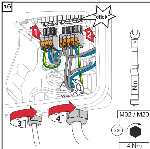
Inserire i morsetti nel rispettivo slot fino a quando non si innestano. Fissare i dadi per raccordi dei pressacavi con una coppia di 4 Nm.
