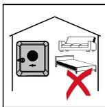
Dato che l'inverter in determinate condizioni di funzionamento può emettere una lieve rumorosità, non montarlo nelle immediate vicinanze di locali ad uso abitativo.
