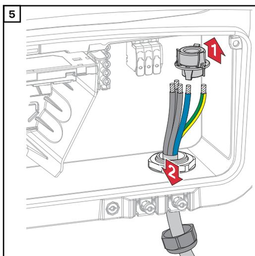
Rimuovere il nucleo di ferrite e rimuovere il cavo di rete dall'inverter.
