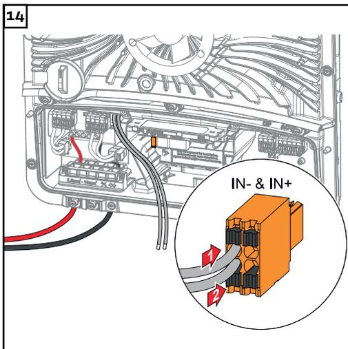
Collegare il cavo di segnale al morsetto a pressione WSD agli slot IN- e IN+, osservando l'etichettatura.
