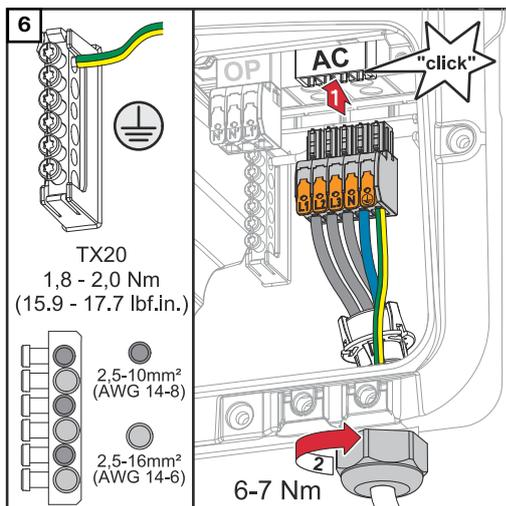
Inserire il morsetto CA nello slot CA fino a quando non scatta in posizione. Fissare il dado per raccordi del pressacavo con una coppia di 6-7 Nm.
