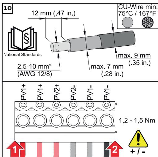
Spelare 12 mm di isolamento dai singoli conduttori e fissarli alla rispettiva fessura del morsetto sulla scheda elettronica con una coppia di serraggio di 1,2-1,5 Nm.
