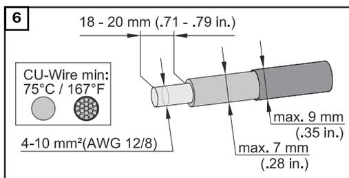
Spellare 18-20 mm di isolamento dai singoli conduttori. Selezionare la sezione del cavo in base alle specifiche riportate in [Cavi consentiti per il collegamento elettrico](#) da pagina 66.
