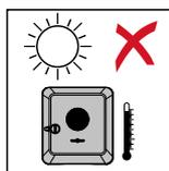
Per ridurre il più possibile il riscaldamento dell'inverter, non esporlo all'irraggiamento solare diretto.
