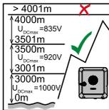
L'inverter non deve essere montato e messo in funzione a un'altitudine superiore a 4000 m.
