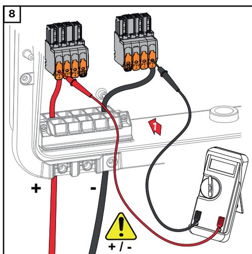
Controllare la tensione e la polarità del cablaggio CC con uno strumento di misura adeguato. Rimuovere entrambi i morsetti CC dagli slot.
