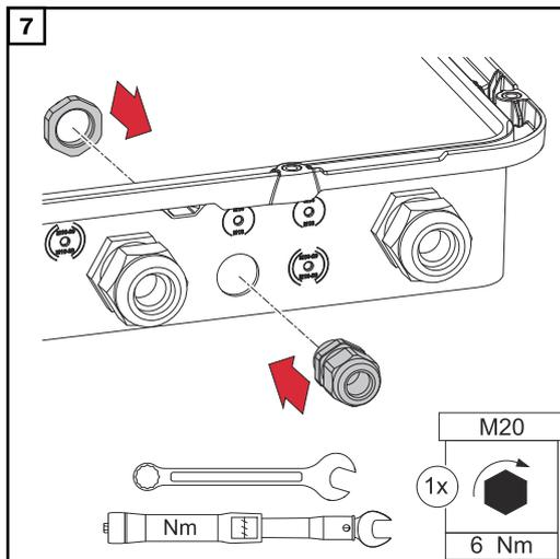
Inserire il pressacavo nel foro e fissarlo con una coppia di 6 Nm.
