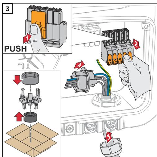
Premere il blocco sul retro del morsetto ed estrarre il morsetto CA. Far passare il cavo di rete dal basso attraverso il pressacavo situato sul lato destro e il nucleo di ferrite.
