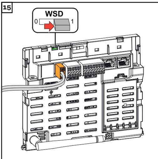
Controllare che il commutatore WSD sia in Posizione 1, eventualmente regolarlo (impostazione di fabbrica: Posizione 1).
