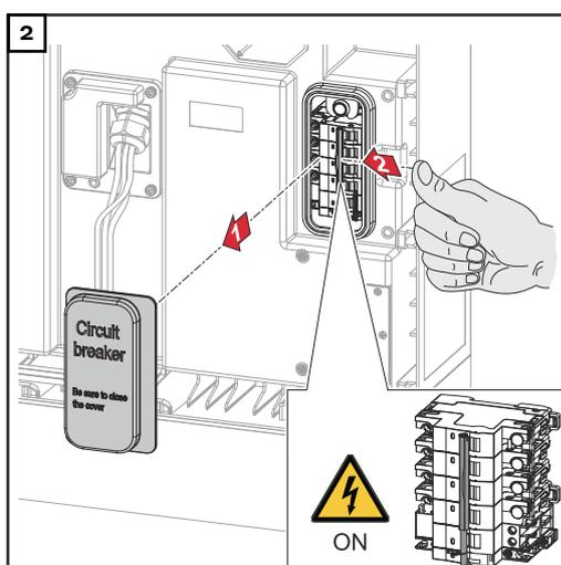
Estrarre la copertura del sezionatore CC tirandola in avanti. Posizionare il sezionatore CC nella posizione di commutazione "On".
