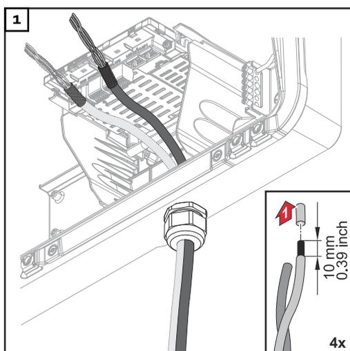
Spelare 10 mm di isolamento dai singoli conduttori e, se necessario, montare i manicotti di fine filo.
