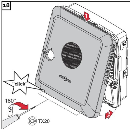
Agganciare il coperchio del corpo esterno all'inverter dall'alto. Premere la parte inferiore del coperchio del corpo esterno e fissare le 2 viti con un cacciavite (TX20) e ruotandole di 180° verso destra.
