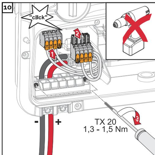
Inserire i morsetti CC nel rispettivo slot fino a quando non si innestano. Fissare le viti del supporto antistrappo al corpo esterno con un cacciavite (TX20) e una coppia di serraggio di 1,3-1,5 Nm.
