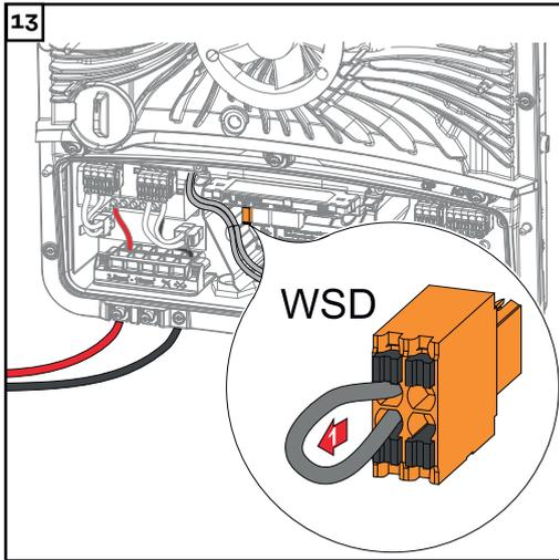
Rimuovere il bypass installato in fabbrica sul morsetto a innesto WSD.
