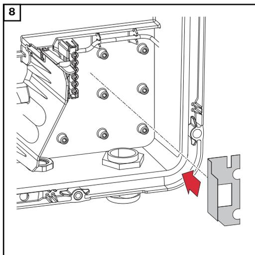
Inserire la pellicola isolante sul lato destro del morsetto dell'elettrodo di terra.
