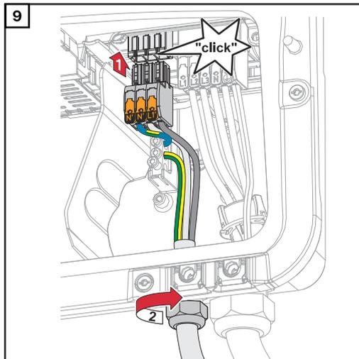
Inserire il morsetto OP nello slot OP fino a quando non scatta in posizione. Fissare il dado per raccordi del pressacavo alla coppia specificata dal produttore.
