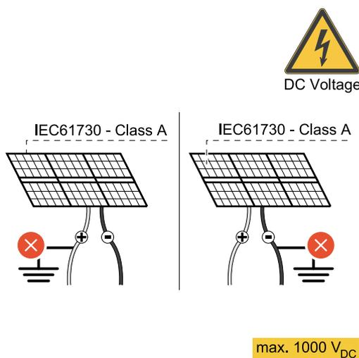
**IMPORTANTE!** I moduli solari collegati all'inverter devono rispondere ai requisiti della norma IEC 61730 Classe A.
