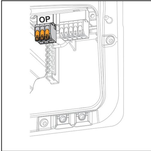
Il PV Point può essere utilizzato per alimentare apparecchi elettrici monofase fino a una potenza massima di 3 kW sul morsetto Opportunity Power (OP) in caso di guasto della rete pubblica, a condizione che sia disponibile una potenza sufficiente dai moduli solari o da una batteria opzionale. Nel funzionamento collegato alla rete non c'è tensione sul morsetto OP, quindi i carichi collegati non sono permanentemente alimentati.
