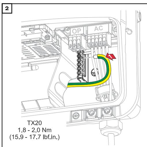
Fissare il conduttore di terra della batteria sul secondo ingresso partendo dall'alto al morsetto dell'elettrodo di terra con un cacciavite (TX20) e una coppia di serraggio di 1,8-2 Nm.
