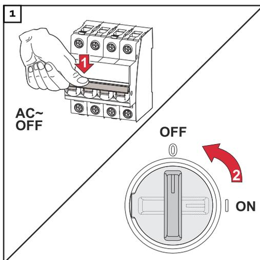
Disinserire l'inverter e attendere che i condensatori si scarichino (2 minuti) e che la ventola si arresti. Portare il sezionatore CC in posizione di commutazione "Off".
