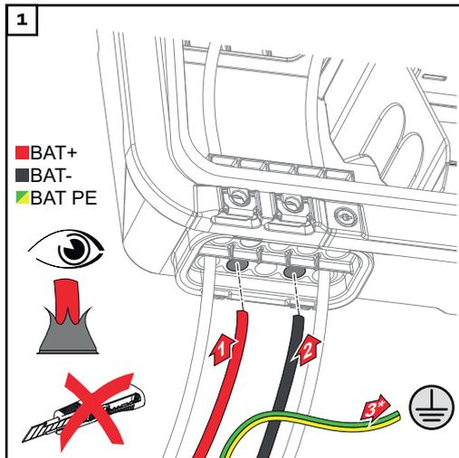
Spingere manualmente i cavi della batteria attraverso i passanti CC.
