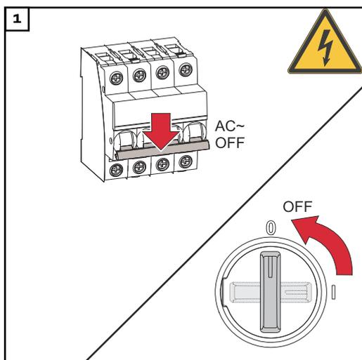
Disattivare l'interruttore automatico e il sezionatore CC. Commutare il sezionatore CC sulla posizione di commutazione "Off".
