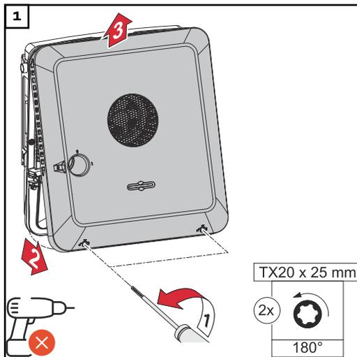
Allentare le 2 viti sul lato inferiore del coperchio del corpo esterno con un cacciavite (TX20) e un giro di 180° verso sinistra. Sollevare quindi il coperchio del corpo esterno sul lato inferiore dell'inverter e sganciarlo verso l'alto.
