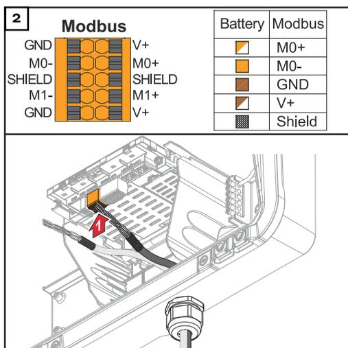
Inserire i cavi nel rispettivo slot e controllare la tenuta dei cavi.
